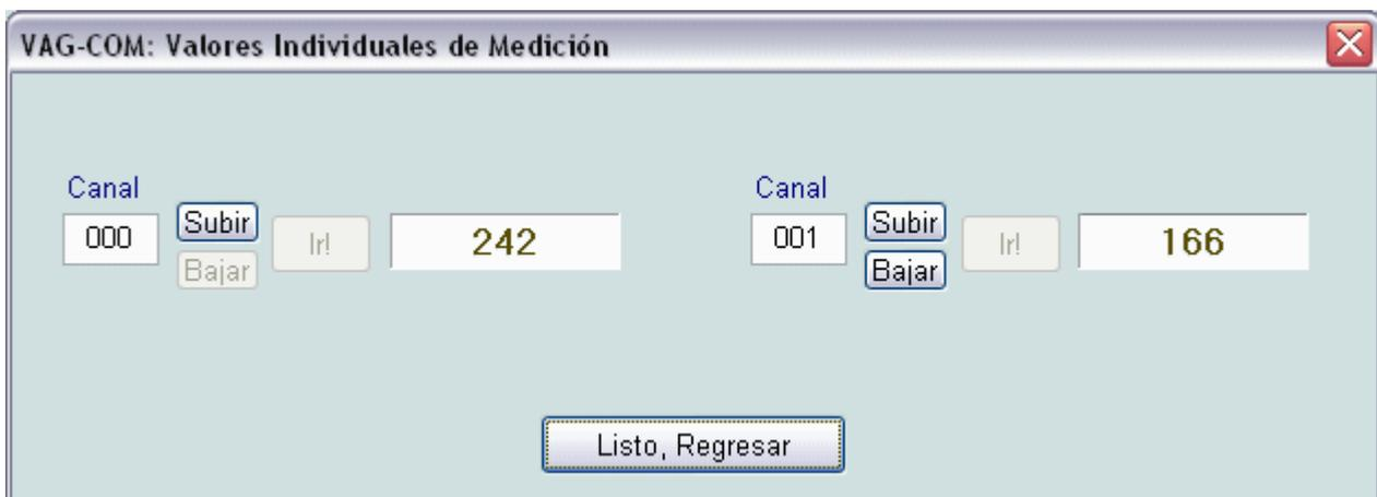
Esta función le permite observar datos en tiempo real de la unidad de control que lo soporte. Sin embargo, los datos provenientes de la unidad de control no explican qué significan los datos o cómo escalarlos a valores reales.
