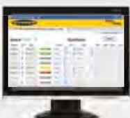
El software "Configuration Tool" utiliza un convertidor de USB a RS-485 para conectarse a un Maestro SureCross estándar mediante un PC. Una vez conectado, el "Configuration Tool" configurará uno a uno cada conexión de E/S y los parámetros de configuración del sistema wireless.
