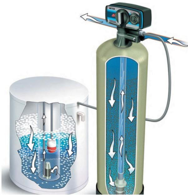
Los suavizadores tienen la finalidad de remover dureza del agua. Esto quiere decir que el calcio y magnesio que producen la dureza, serán removidos casi por completo del agua que se va a tratar.
