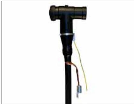
El tapón aislante a prueba de tensión tipo CIK ofrece aislamiento y apantallamiento eléctrico a pasatapas tipo A 250 A y C 630 A (según EN 50180 y EN 50181) de tensión máxima de red de hasta 36kV.
