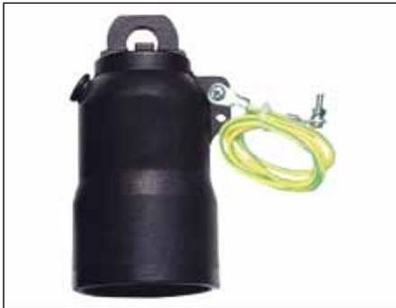
El tapón aislante a prueba de tensión ofrece aislamiento eléctrico para pasatapas de tipo A 250 A y C 630 A en subestaciones encapsuladas y transformadores hasta 36 kV, en cumplimiento con las normas EN 50180 and EN 50181.
