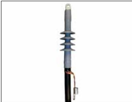
Las terminaciones exteriores tipo CAESK-F son aptas para cables unipolares con aislamiento sintético (PVC, PE, VPE, EPR) de diferentes tipos de semiconductores (grafitizadas, extraíbles o pelables) y estructuras de pantalla (pantalla de hilos de Cu o de cinta de Cu).
