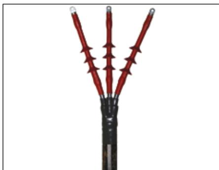
Las terminaciones exteriores tipo CHEP(3Pb)-3F, son aptas para todos los cables tripolares con aislamiento de papel aceite de tres plomos desde 24 hasta 36 kV. Nota: Sólo apto para cables con aislamiento de aceite de masa no migrante. Consúltenos en caso de aplicación en otros tipos de cables.
