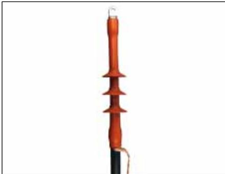
Las terminaciones exteriores tipo CHE-F son aptas para cables unipolares con aislamiento sintético (PVC, PE, VPE, EPR) de diferentes tipo de semiconductor (grafitizadas, extraíbles o pelables) y estructura de pantalla (pantalla de hilos de Cu o de cinta de Cu).
