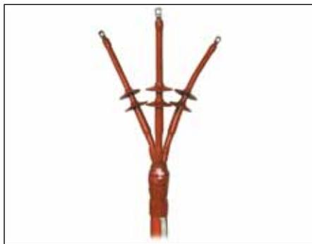
Las terminaciones interiores tipo CHE-3I(B) son aptas para cables tripolares con aislamiento sintético (PVC, PE, VPE, EPR) de diferentes tipos de semiconductoras (grafitizadas, extraíbles o pelables) y estructuras de pantalla (pantalla de hilos de Cu o de cinta de Cu). Válidas para terminales a compresión.
