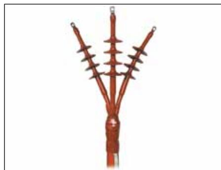
Las terminaciones exteriores tipo CHE-3F(B) son aptas para cables tripolares con aislamiento sintético (PVC, PE, VPE, EPR) de diferentes tipos de semiconductoras (grafitizadas, extraíbles o pelables) y estructuras de pantalla (pantalla de hilos de Cu o de cinta de Cu).
