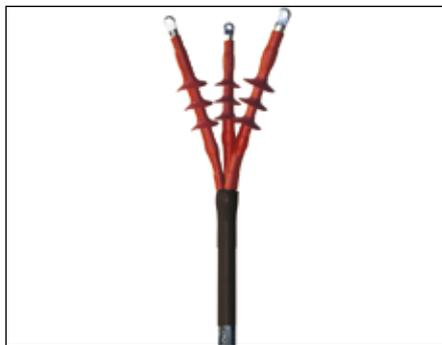
Las terminaciones exteriores tipo CHP(H)-3F, son aptas para cables tripolares con aislamiento de papel aceite tipo Hoechstaedter desde 24 hasta 36 kV. Nota: Sólo apto para cables con aislamiento de aceite de masa no migrante. Consúltenos en caso de aplicación en otros tipos de cables.
