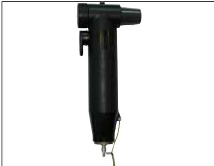
Los conectores enchufables de acople con pararrayo integrado tipo CTKSA están diseñados para la protección de instalaciones de media tensión equipadas con pasatapas de cono externo tipo C (según EN 50180 y EN 50181) de tensión máxima de red de hasta 24 kV. Su diseño compacto permite la conexión directa a conectores enchufables roscados tipo CTS 630 A y cumplen con la Norma Internacional IEC 60099-4.
