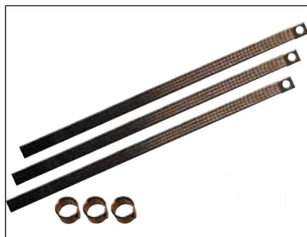
Conjuntos de puesta a tierra tipo EGA para terminaciones unipolares para cables con pantalla de cinta de cobre o pantalla de aluminio (figura 1) así como para cable tripolar sin armadura (figura 3). Partes integrantes: 3 trenzas planas de cobre estañado y 3 muelles de presión.
