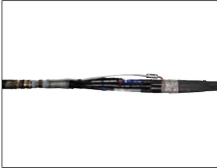
Los empalmes de transición tipo CHMP(H)3 son aptos para la conexión entre cables tripolares con aislamiento de papel aceite tipo Hoechstaedter con cables tripolares con aislamiento sintético desde 24 hasta 36 kV. Por medio de los correspondientes juegos de adaptación para el cable con aislamiento de papel, puede expandirse el rango de aplicación a secciones mas pequeñas.
