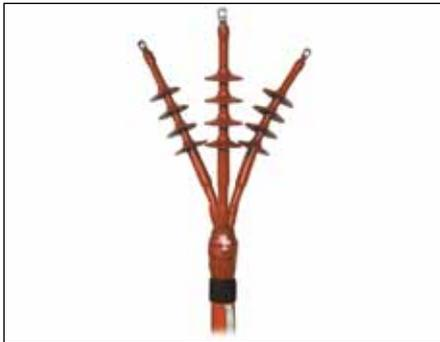
Las terminaciones exteriores tipo CHE-3F(BS) son aptas para cables tripolares con aislamiento sintético (PVC, PE, VPE, EPR) de diferentes tipos de semiconductoras (grafitizadas, extraíbles o pelables) y estructuras de pantalla (pantalla de hilos de Cu o de cinta de Cu).
