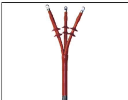
Las terminaciones exteriores tipo CHP-3F, son aptas para todo tipo de cables tripolares con aislamiento de papel aceite (cinturado) monoplomo de hasta 17.5 kV. Nota: Sólo apto para cables con aislamiento de aceite de masa no migrante. Consúltenos en caso de aplicación en otros tipos de cables.
