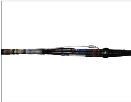
Los empalmes de transición tipo CHMPR3-1 son aptos para la conexión entre cables tripolares con aislamiento de papel aceite tipo monoplomo (cinturado) o tipo Hoechstdaeter con tres cables unipolares con aislamiento sintético hasta 17.5 kV. Por medio de los correspondientes juegos de adaptación para el cable con aislamiento de papel, puede expandirse el rango de aplicación a secciones mas pequeñas.
