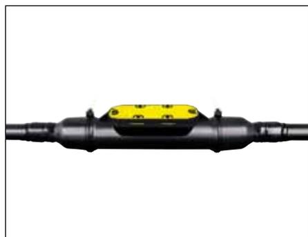
El empalme unipolar enchufable tipo CKM es apto para la conexión de cables unipolares con aislamiento sintético (PE, VPE, EPR) de diferentes tipos de semiconductores (grafitizadas, extraíbles o pelables) y estructuras de pantalla (pantalla de hilos o de cinta de Cu) para tensiones máximas de red de hasta 24 kV. Con conector a tornillería integrado.
