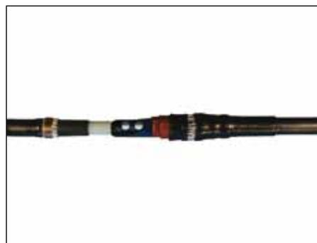
Los empalmes tipo CHMSV son aptos para cables unipolares con aislamiento sintético (PVC, PE, XLPE, EPR). Permiten la conexión de cables de diferentes secciones y materiales de conductor como también de diferente construcción respecto a las semiconductoras (grafitadas, extraíbles o pelables) y a la estructura de pantalla (hilos o cintas de cobre).
