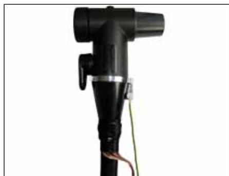
Los conectores enchufable de acople tipo CTKS 630A son aptos para la conexión de cables con aislamiento sintético (PVC, PE, VPE, EPR) de diferentes tipos de semiconductoras. (grafitizadas, extraíbles o pelables) y estructuras de pantalla (pantalla de hilos de Cu o de cinta de Cu), permitiendo una conexión directa de los mismos sobre conectores enchufables Cellplux tipo CTS 630 A kV sin necesidad de elementos de acople adicional hasta 36kV
