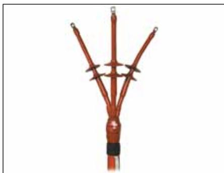
Las terminaciones interiores tipo CHE-3I(BS) son aptas para cables tripolares con aislamiento sintético (PVC, PE, VPE, EPR) de diferentes tipos de semiconductoras (grafitizadas, extraíbles o pelables) y estructuras de pantalla (pantalla de hilos de Cu o de cinta de Cu). Válidas para terminales a compresión.
