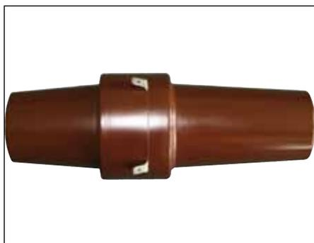
El elemento de acople roscado CKS está diseñado para la conexión de dos conectores enchufables tipo CTS 630A de hasta 24 kV para una corriente nominal de 630 A. Las dimensiones del cono exterior más largo corresponden al pasatapas de cono exterior tipo C según EN 50180 y EN 50181.
