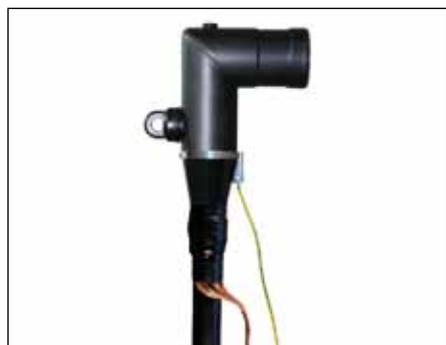
Los conectores enchufables acodados Cellplex tipo CWS 400A son aptos para la conexión de todos los cables con aislamiento sintético (PVC, PE, XLPE, EPR) con diferentes tipos de semiconductoras (grafitizadas, extraíbles o pelables) y estructuras de pantalla (pantalla de hilos de Cu o de cinta de Cu) para montaje en equipos y transformadores con pasatapas de cono exterior tipo B (según EN 50180, EN 50181 y DIN 47636) de tensión máxima de red de hasta 36 kV.
