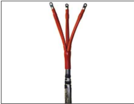
Las terminaciones interiores tipo CHEP-3I, son aptas para cables con aislamiento de papel aceite monoplomo (cinturado). Sólo apto para aislamiento de papel aceite de masa no migrante. Consúltenos para su aplicación en otros tipos de cables.
