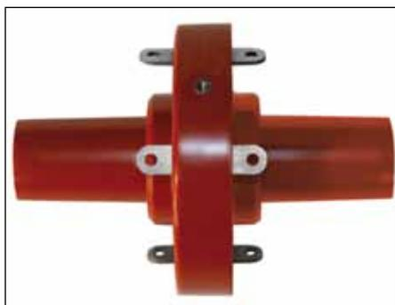
El elemento de acople enchufable CVS está diseñado para la conexión de dos conectores enchufables tipo CWS 250A y/o CGS 250A de hasta 24 kV entre si para una corriente nominal de 250 A. Las dimensiones del cono exterior corresponden al pasatapas de cono exterior tipo A según EN 50180, EN 50181 y DIN 47636.
