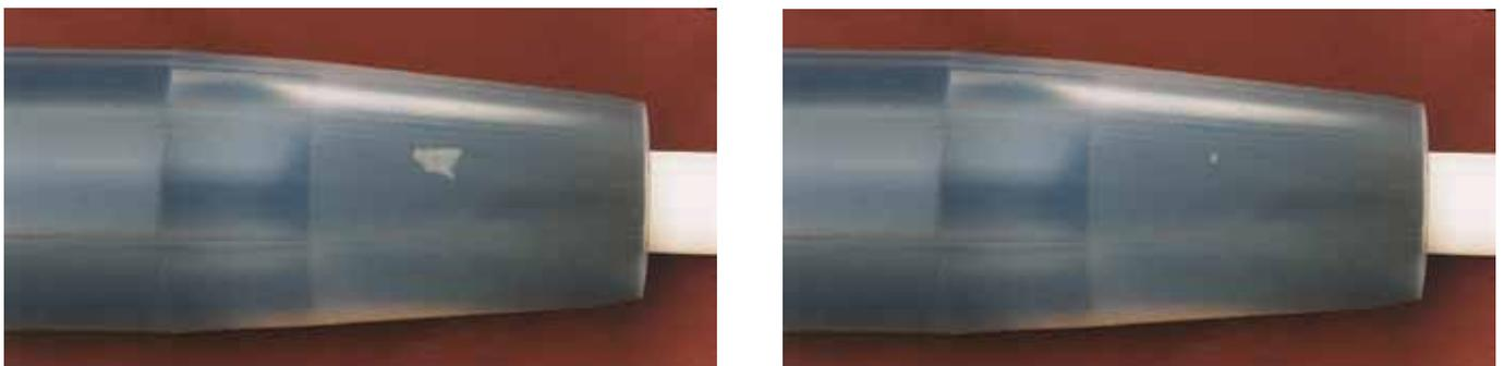
Fig. 2: Difusión de burbujas de aire en aislamiento de caucho de silicona y FSE
