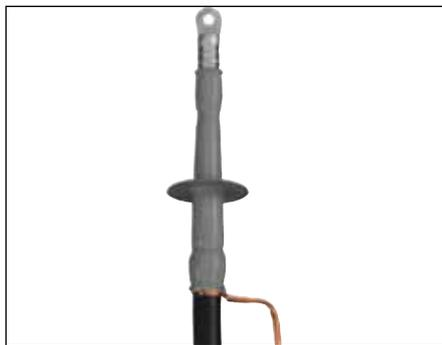
Las terminaciones interiores tipo CAE-I son aptas para cables unipolares con aislamiento sintético (PVC, PE, VPE, EPR) de diferentes tipos de semiconductoras (grafitizadas, extraíbles o pelables) y estructuras de pantalla (pantalla de hilos de Cu o de cinta de Cu). Válidas para terminales a compresión.
