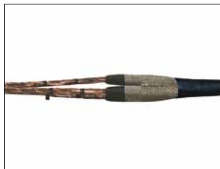
Los empalmes tipo CAM3-S son aptos para cables tripolares con aislamiento sintético (PVC, PE, VPE, EPR). Posibilitan la conexión de cables de diferentes secciones y materiales de conductor como también de diferente construcción respecto a las semiconductoras (grafitizadas, extraíbles o pelables) y estructura de pantalla (pantalla de hilo de cobre o de cinta).
