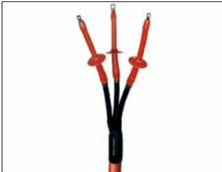
Las terminaciones interiores tipo CHE-3I(A) son aptas para cables tripolares con aislamiento sintético (PVC, PE, VPE, EPR) de diferentes tipos de semiconductoras (grafitizadas, extraíbles o pelables) y estructuras de pantalla (pantalla de hilos de Cu o de cinta de Cu). Válidas para terminales a compresión.
