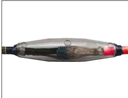
Los empalmes de transición tipo M.MSPB6 son aptos para conectar cables con aislamiento de papel aceite monoplomo (cinturado) con cables poliméricos tripolares (PVC, PE, VPE, EPR) sin semiconductor exterior. Posibilitan la conexión de cables de diversas secciones y materiales de conductor, incluso de diferente tipo de reconstrucciones. No contienen sustancias que impidan la aplicación de pintura y pueden emplearse en las instalaciones de la industria del automóvil.
