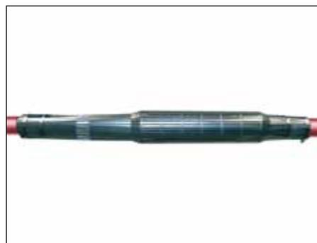
Los empalmes tipo CHM(BS) son aptos para cables unipolares con aislamiento sintético (PVC, PE, VPE, EPR). Posibilitan la conexión de cables de diferentes secciones y materiales de conductor como también de diferente construcción respecto a las semiconductoras (grafitizadas, extraíbles o pelables) y a la estructura de pantalla (pantalla de hilo de cobre o de cinta).
