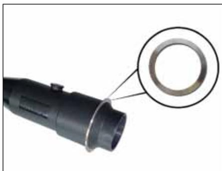
El anillo de montaje está diseñado para proteger los conectores enchufables Cellplux CWS 250A y CGS 250A de un pasatapas especial de cono exterior tipo A. El anillo de montaje está simplemente situado en una ranura prefabricada en el conector del cable. Los dos componentes podrían instalarse juntos en el pasatapas.
