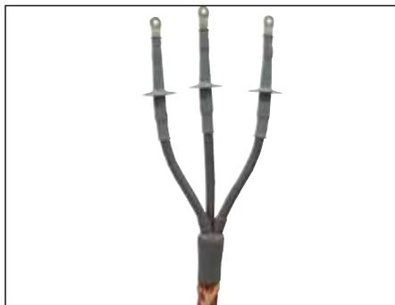
Las terminaciones interiores tipo CAE-3I son aptas para cables tripolares con aislamiento sintético (PVC, PE, VPE, EPR) de diferentes tipos de semiconductoras (grafitizadas, extraíbles o pelables) y estructuras de pantalla (pantalla de hilos de Cu o de cinta de Cu).
