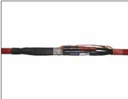
Los empalmes tipo CHM3 son aptos para cables tripolares con aislamiento sintético (PVC, PE, VPE, EPR). Posibilitan la conexión de cables de diferentes secciones y materiales de conductor como también de diferente construcción respecto a las semiconductoras (grafitizadas, extraíbles o pelables) y a la estructura de pantalla (pantalla de hilo de cobre o de cinta). Apto para conectores a compresión. Solución especial para NUON / Países bajos
