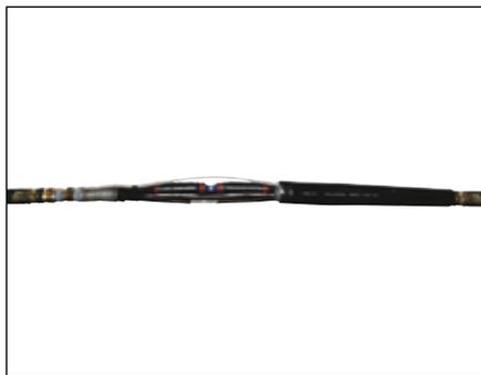
Los empalmes Hybrid tipo CHMPP(H)3, son aptos para la conexión recta entre cables con aislamiento de papel aceite tipo Hoechstaedter desde 24 hasta 36 kV. Por medio de los correspondientes juegos de adaptación (compare con empalmes de transición) puede expandirse el rango de aplicación a secciones mas pequeñas.
