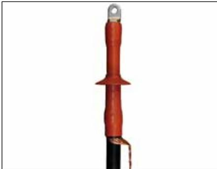
Las terminaciones interiores tipo CHE-I son aptas para cables unipolares con aislamiento sintético (PVC, PE, VPE, EPR) de diferentes tipos de semiconductoras (grafitizadas, extraíbles o pelables) y estructuras de pantalla (pantalla de hilos de Cu o de cinta de Cu).
