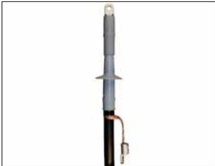
Las terminaciones interiores tipo CAESK-I son aptas para cables unipolares con aislamiento sintético (PVC, PE, VPE, EPR) de diferentes tipos de semiconductores (grafitizadas, extraíbles o pelables) y estructuras de pantalla (pantalla de hilos de Cu o de cinta de Cu).
