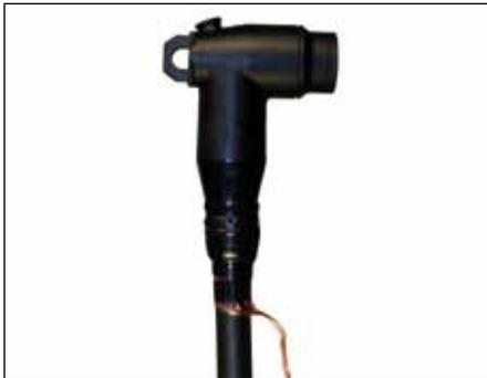
Los conectores enchufables acodados Cellplux tipo CWS 250A son aptos para la conexión de todos los cables con aislamiento sintético (PVC, PE, XLPE, EPR) con diferentes tipos de semiconductoras (grafitizadas, extraíbles o pelables) y estructuras de pantalla (pantalla de hilos de Cu o de cinta de Cu) para montaje en equipos y transformadores con pasatapas de cono exterior tipo A (según EN 50180, EN 50181 y DIN 47636) de tensión máxima de red de hasta 24 kV.
