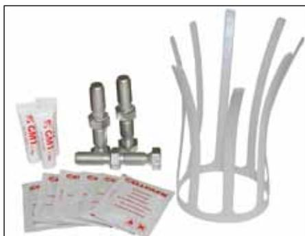
El juego de accesorios ZS-CTS está diseñado para la reinstalación de conectores enchufables tipo CTS 630A en subestaciones y transformadores con pasatapas con cono exterior tipo C según EN 50180 y EN 50181. Contiene los bulones roscados con cabeza fusible integrada para la nueva fijación de los conectores a los pasatapas, eliminando toda posibilidad de montajes defectuosos.
