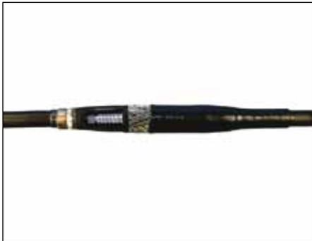
Los empalmes tipo CAM-S son aptos para cables unipolares con aislamiento sintético (PVC, PE, VPE, EPR). Posibilitan la conexión de cables de diferentes secciones y materiales de conductor, como también de diferente construcción respecto a las semiconductoras (grafitizadas, extraíbles o pelables) y a la estructura de pantalla (pantalla de hilo de cobre o de cinta).
