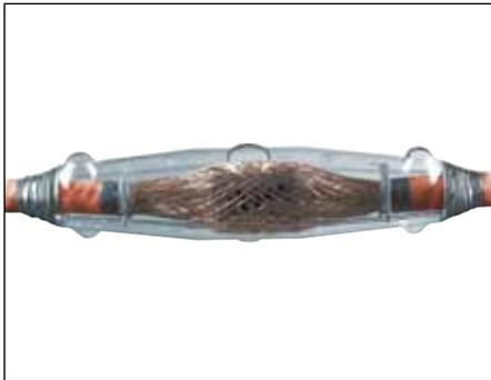
Los empalmes tipo M.MS6 son aptos para cables tripolares con aislamiento sintético (PVC, PE, VPE, EPR) sin semiconductora exterior. Posibilitan la conexión de cables de diferentes secciones y materiales de conductor, incluso con diferentes construcciones de cable. No contienen sustancias que impidan la aplicación de pintura y pueden emplearse en las instalaciones de la industria automotriz.
