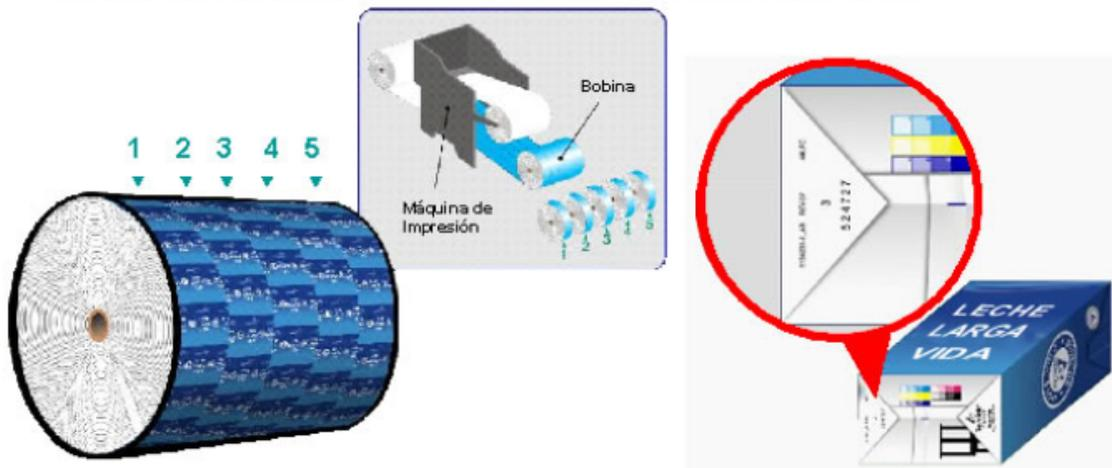
Los envases de Tetra Pak se producen en grandes bobinas como ésta que tiene 1,60 mt de ancho. Esta bobina contiene varios rollos con secuencias de envases.
