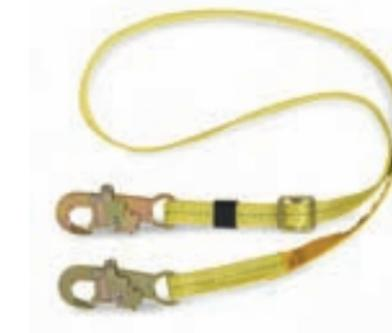
Este cordón tiene broches de autocierre en cada extremo y se lo puede ajustar desde los 4 hasta los 8 pies (1,2 a 2,4 m). Su tela de poliéster de 1-plg. (25 mm) cuenta con un indicador de desgaste incorporado.
