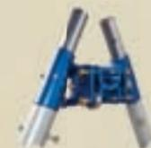
**Bípode** – ofrece buena estabilidad en una dirección, pero debe estar afianzado con cables en forma segura. No puede posicionarse en cuadro o lateralmente a la dirección de la carga
