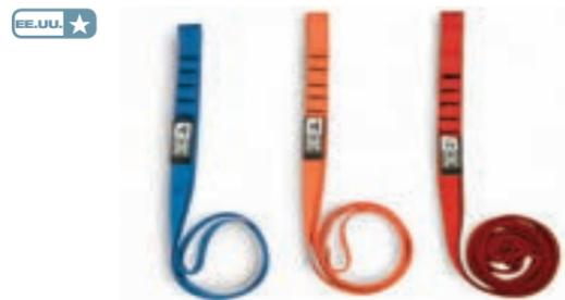
Diseñadas para brindar protección al subir torres, nuestras lazadas funcionales otorgan versatilidad al colocar amarres. Cosidas con tela tubular de especificaciones militares de 1-plg. (25-mm) para lograr una alta resistencia y buen agarre cuando están sujetas a un nudo de alondra, la resistencia mínima a la rotura (lazada) es de 24 kN (5.400 lbf.).
