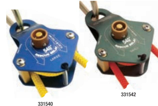
El Traverse 540° es un dispositivo de alta ingeniería, de autocierra, patentado y fácil de aparejar que cumple con los criterios de prueba de caídas: capaz de sostener cargas que caen rápidamente mientras limita la fuerza máxima. Su diseño simétrico reduce el riesgo de aparejamiento involuntaria. Una palanca de liberación incorporada descarga la tensión sobre la cuerda de amarre, eliminando la necesidad de contar con un nudo de liberación.
