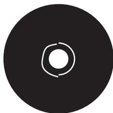
Fractura o fisura alrededor de la brida de apriete. Disco sin rigidez.
