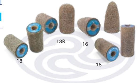
Ruedas resinoides tipo 11 con buje roscado, fabricadas con óxido de aluminio regular o una combinación de óxido de aluminio con carburo de silicio negro para desbaste de materiales ferrosos con máquinas portátiles americanas y europeas.(Dibujo 18236)
