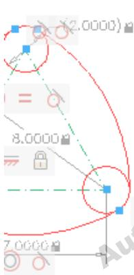
10. Cree el perfil de los montantes giratorios como se muestra. Luego, utilice el comando AutoConstrain para restringirlo al rectángulo principal en la vista lateral. **Sugerencia:** asegúrese de seleccionar toda la geometría de la vista lateral.
