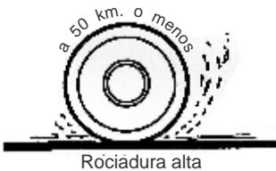
A baja velocidad, el neumático corta el agua en el punto de contacto con el pavimento y se mantiene en contacto absoluto con el mismo.
