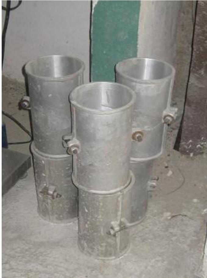
Moldes cilíndricos para confeccionar probetas de hormigón de 15 cm de diámetro y 30 cm de altura torneados interiormente y con base metálica torneada o cepillada
