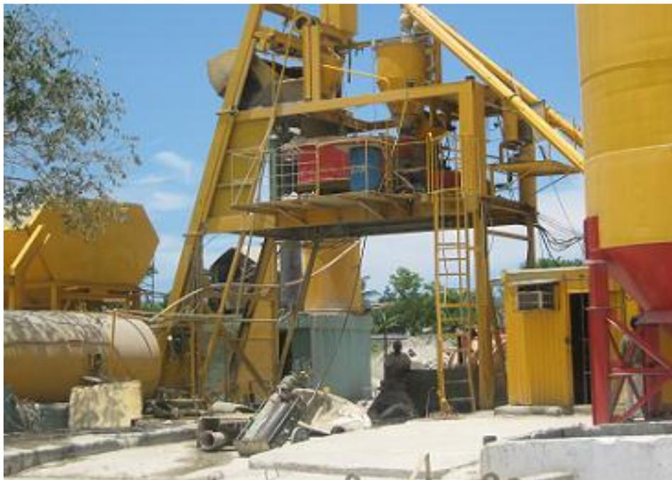
**1.19. Canal por donde se transporta el árido fino y grueso hacia el cubo que los transporta hacia el mezclador.**
