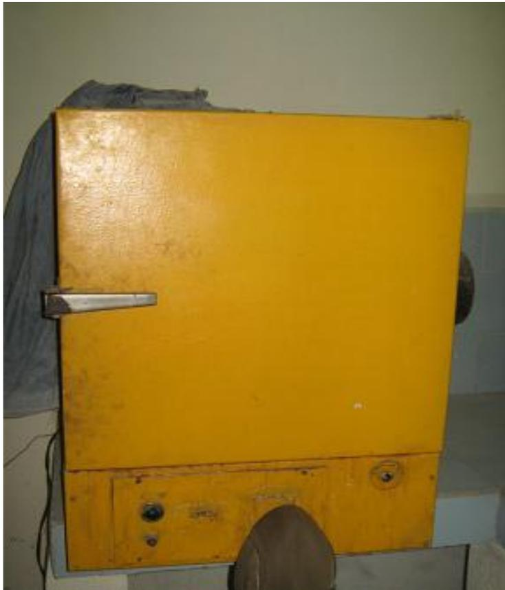
Estufa para secado de agregados capaz de mantener una temperatura de 100°C a 110°C.
