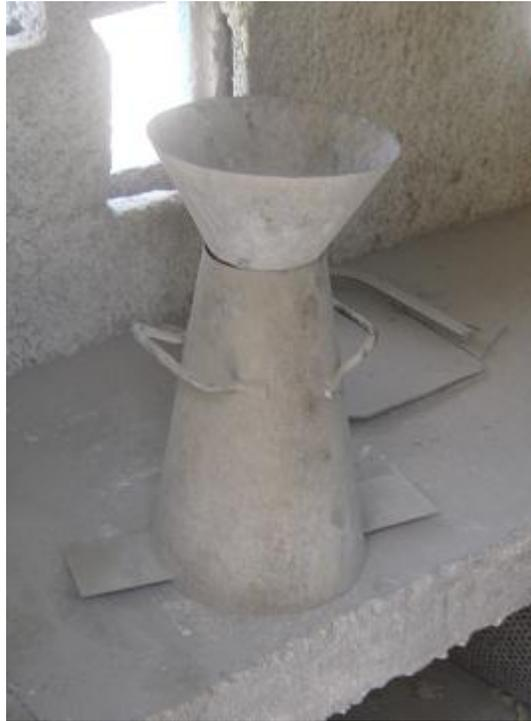
Cono de chapa galvanizada para el ensayo de asentamiento de cono de Abrams
