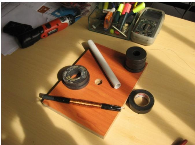
Luego, hicimos un orificio para fijar el tubo a la base y colocamos los imanes enfrentados como muestran las figuras 5 y 6, de tal forma que el generador quedó firme.
