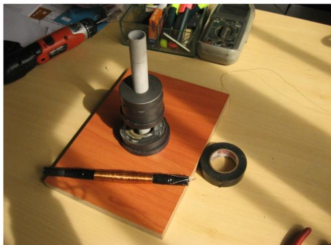
Introducimos la bobina en el tubo y el generador quedó terminado (figuras 6 y 7):
