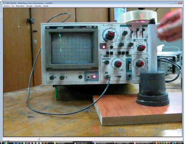
En la figura se observa que la curva de voltaje en función del tiempo que muestra el osciloscopio es aproximadamente sinusoidal. El proceso desde que el imán se encuentra arriba del tubo hasta que baja representa una longitud de onda en la pantalla del osciloscopio. A partir de la misma curva podemos conocer la fem máxima generada y el tiempo transcurrido.
