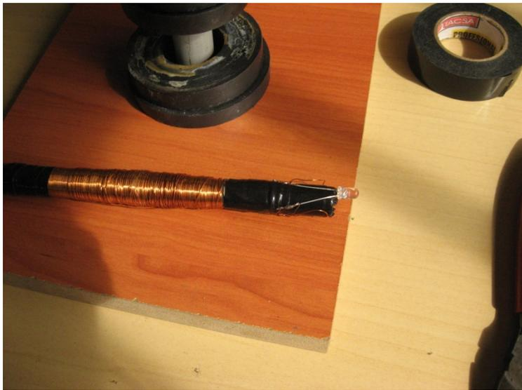
Una vez verificado el funcionamiento del generador y probado que el led se encendía, proseguimos con el armado del generador sobre la base.
