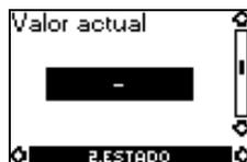
El valor actual medido de un sensor conectado aparece en esta pantalla.
