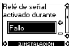
Se selecciona relé de señal de fallo, funcionamiento o preparada para funcionar según la situación en que el relé deba activarse:
