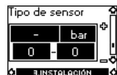
Se ajusta el sensor sólo en el caso de funcionamiento controlado.
