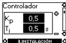
En esta pantalla pueden ajustarse la ganancia ( $K_p$ ) y el tiempo de accionamiento integral ( $T_i$ ) del controlador PI incorporado si el ajuste de fábrica no es el óptimo:
