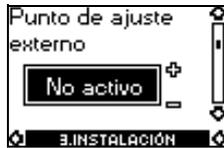
La entrada para la señal externa del punto de ajuste puede ajustarse a diferentes tipos de señal.
