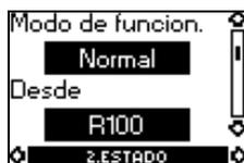
Esta pantalla muestra el modo de funcionamiento actual (Parada, Mín., Normal (trabajo) o Máx.). Muestra además dónde se eligió este modo de funcionamiento (R100, bomba, BUS, externo o función de parada). Para información adicional de la función de parada, ver Ajuste de la función de parada de la página 25.
