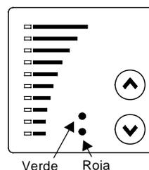
Fig. 55 Panel de control del motor MGE
