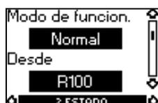
Esta pantalla muestra el modo de funcionamiento actual (Parada, Mín., Normal (trabajo) o Máx.). Muestra además dónde se eligió este modo de funcionamiento (R100, bomba, BUS, o externo).
