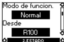
Esta pantalla muestra el modo de funcionamiento actual (Parada, Mín., Normal (trabajo) o Máx.). Además muestra dónde se eligió este modo de funcionamiento (R100, bomba, BUS, Externo).
