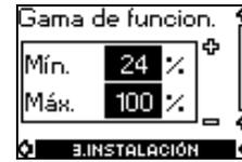
Si debe reducirse la gama de funcionamiento, ajustar las curvas mín. y máx. en % del funcionamiento máximo.
