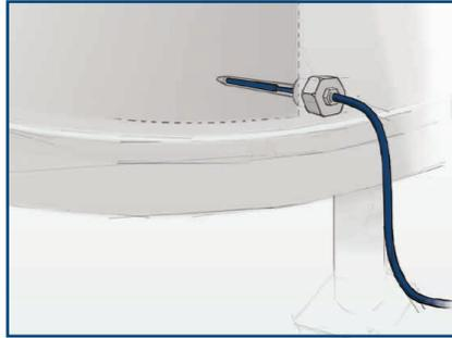
Abb.: Temperaturmessung an einem Boiler
