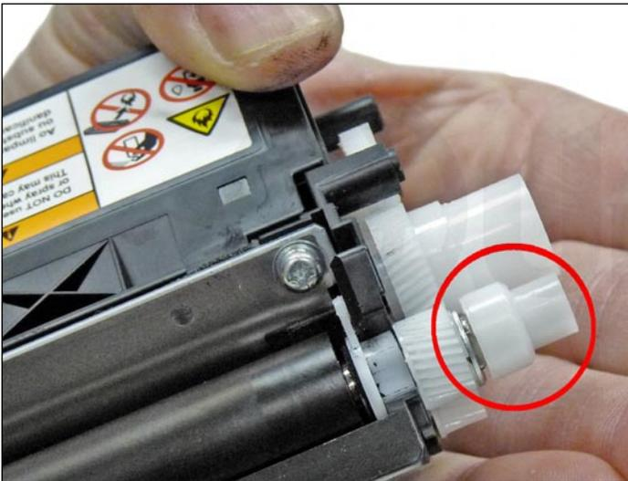
25. Instale los bujes del rodillo revelador.
