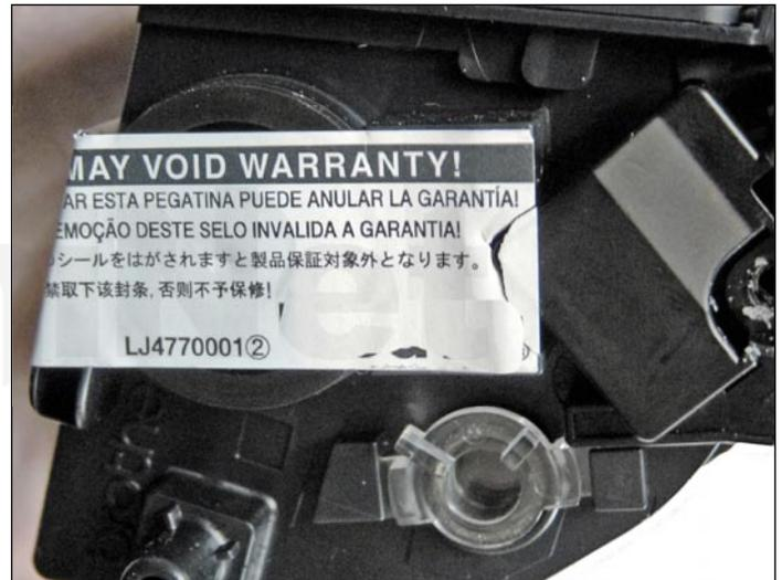
1. Aspire el exterior del cartucho. Tenga cuidado de no dañar el rodillo revelador, ya que esta expuesto. Remueva el tapón de llenado del cartucho de tóner. Sacuda el tóner de desperdicio y aspire/sople el cartucho. Probablemente el tapón de llenado tendrá una etiqueta, se despegar con un poco el alcohol y un paño libre de pelusa o hisopo de algodón.
