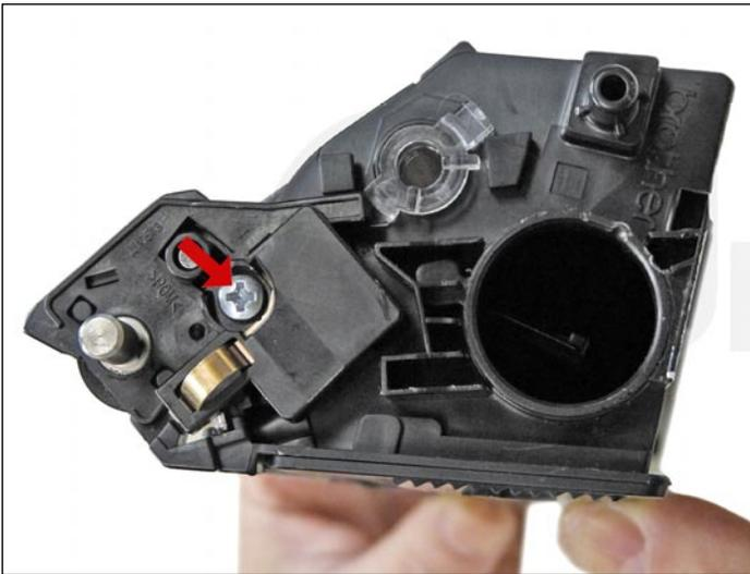
18. Instale la cubierta lateral y los tornillos.
