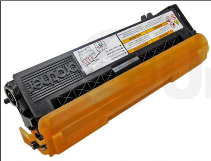
29. Instale la cubierta del rodillo revelador. Esto es importante ya que el rodillo revelador esta expuesto y se daña o contamina muy fácilmente.
